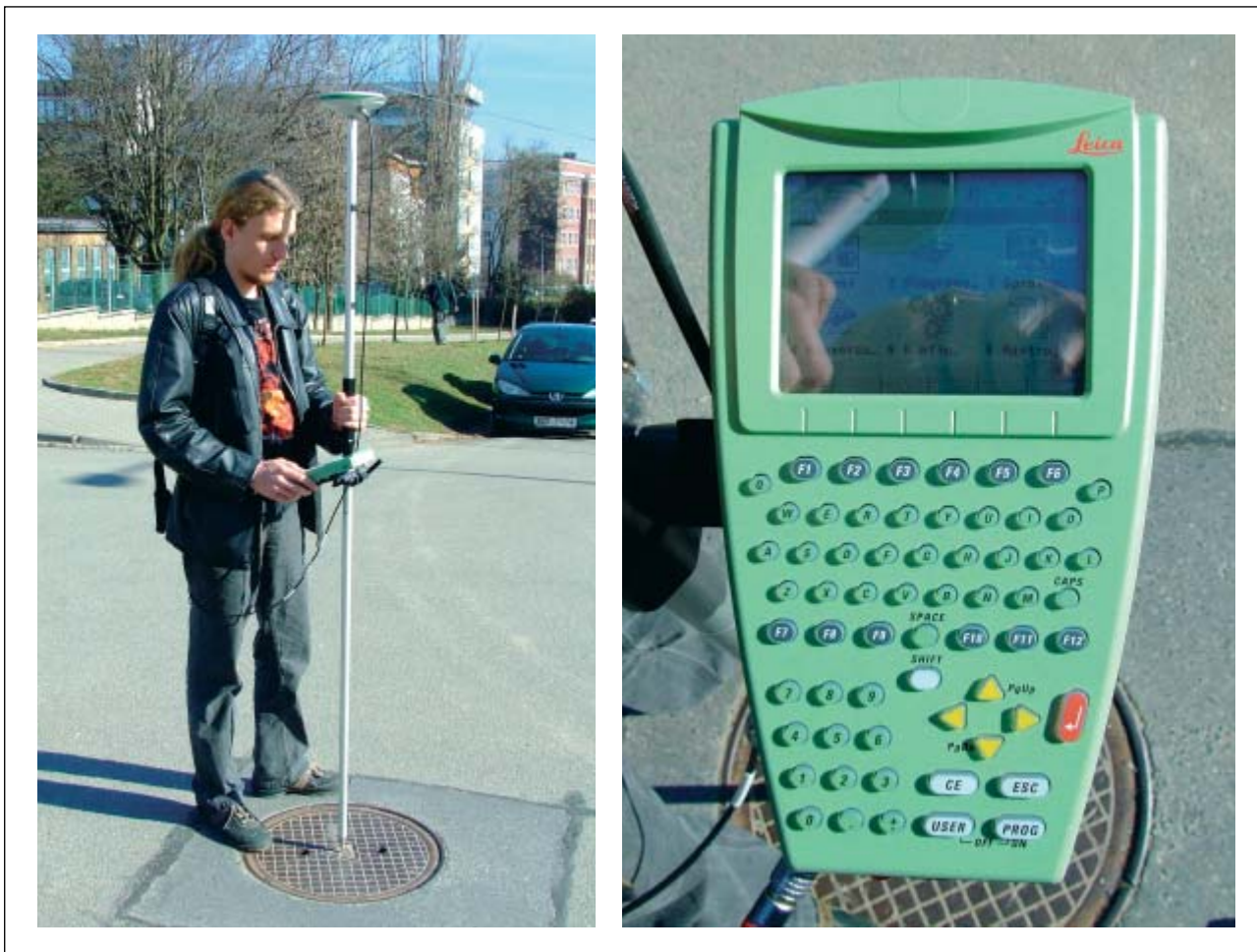
Obr. 4: Měření pomocí přístroje pracujícího na systému komunikace s družicemi a stanicemi.
