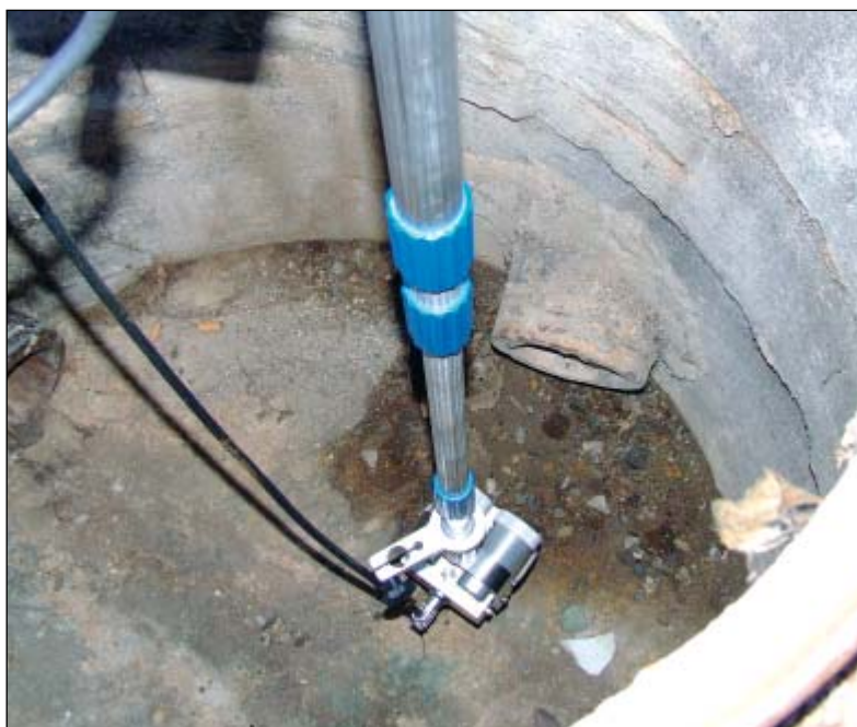
Obr. 3: Průzkum pomocí šachtové kamery – pohled na kamerovou hlavu
