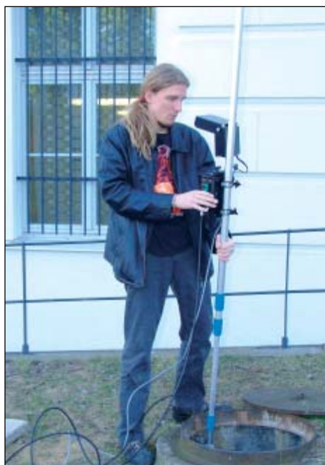
Obr. 2: Průzkum pomocí šachtové kamery
