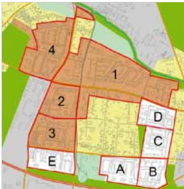
Schéma strategie přestavby: 1 až 4 zachovávané části sídliště, A až E demolice a nové uspořádání
