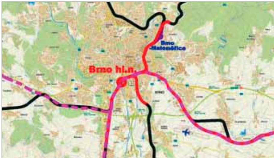
Schéma zapojení VRT do železničního uzlu Brno
