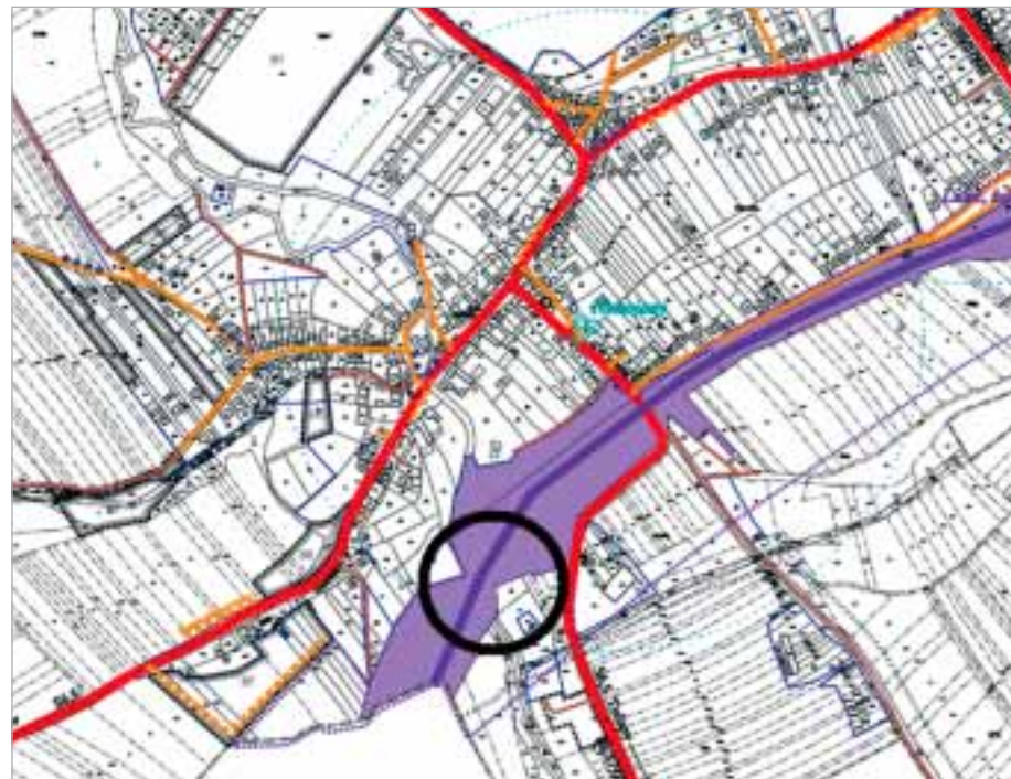
Obr. 5 Na obrázku je patrné velké zúžení, které při přípravě navazujících přípravných dokumentací bylo potřebné změnit (nebylo použito šrafování, proto bylo omylem z naší strany vydáno nesprávné stanovisko k řízení)
