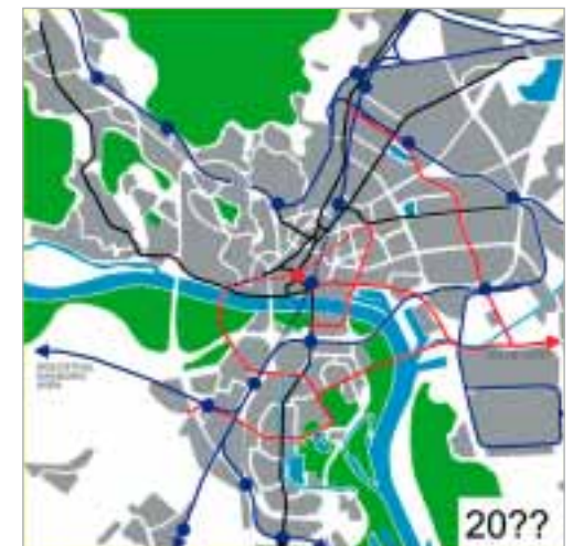
Obr. 12 Scenár 2: Priečna V–Z podzemná trasa električky križuje S–J podzemnú trať železnice
