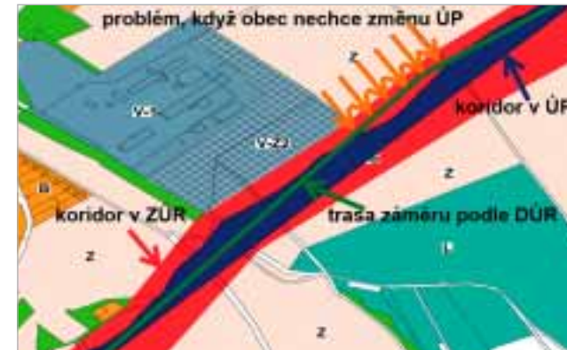
Příklad možné aplikace ustanovení § 54 odst. 5 stavebního zákona při vybočení záměru (zelená linie) z koridoru vymezeného v územním plánu (modrý koridor)
