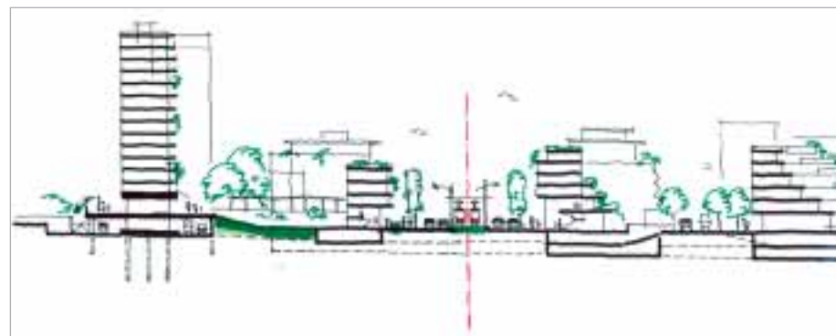
Obr. 9 Návrh na mestský bulvár s profilom jedného jazdného a jedného odstavňového pruhu
