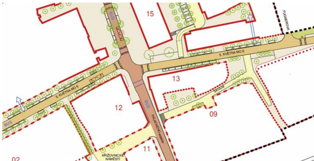
Obr. 6: Výřez z výkresu veřejných prostranství regulačního plánu, řešícího podrobně uspořádání ulic, parkovacích stání i umístění stromořadí 13
