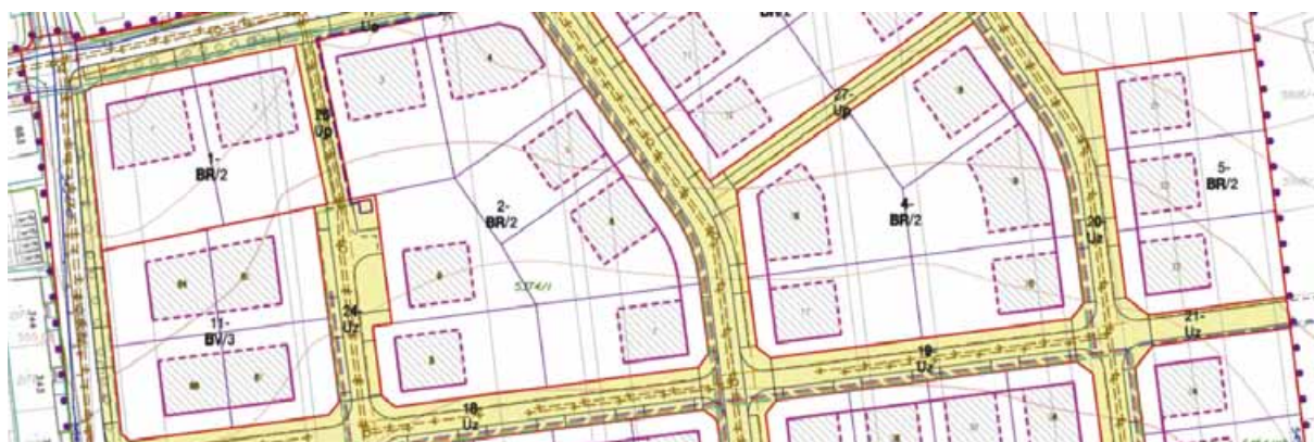
Obr. 4: Výřez z výkresu technické infrastruktury regulačního plánu, který podrobně vymezuje polohu kanalizace, plynovodu i sítí elektro 11
